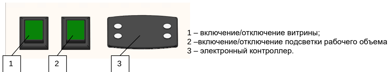
Рисунок 3. Внешний вид панели управления и назначение кнопок.
